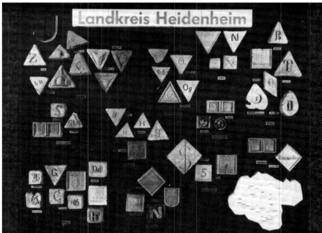
Abb. 9: Die Zeugentafel des Kreises Heidenheim, im Landesvermessungsamt Stuttgart. In der rechten Hälfte zwei glasierte Zeugen, einer aus Burgberg, der andere aus Giengen an der Brenz. Letzterer ist in Abb. 10 zu sehen. Mit freundlicher Genehmigung des Landesvermessungsamtes Stuttgart.
