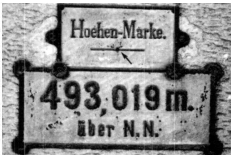
Abb. 5: Höhentafeln beim Bahnhof Heidenheim. Der Pfeil weist auf ein kleines Loch, das die Höhe 493,019 m ü. NN angibt. Foto: B. Häck.
